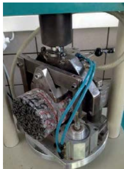
Appareillage pour la détermination de l'adhésion intercouche d'enrobé bitumineux.
